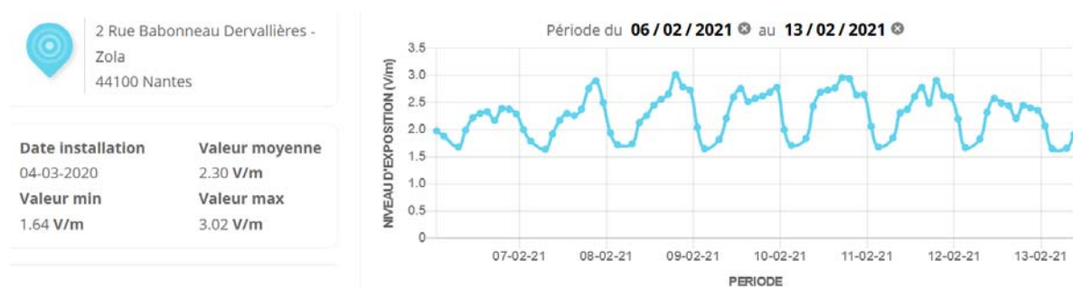
Figure 21 : Exemple d'enregistrement du champ total mesuré en un point fixe de Nantes
